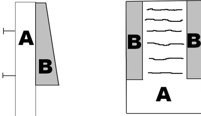
Seitenteile B mit Schrauben auf Grundplatte A befestigen.
