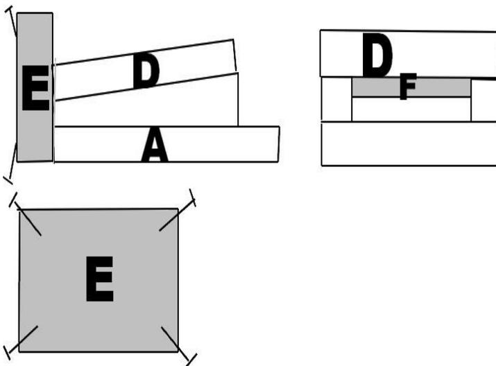
Dachplatte E am spitzen Ende wie auf Abbildung an A und D befestigen. Leiste F von innen an Platte D anschrauben.
