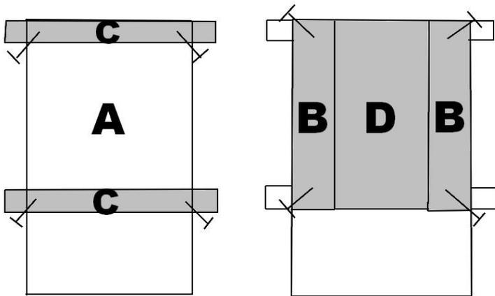
Leisten C auf Rückseite von Grundplatte A Befestigen. Danach Platte D auf Seitenteile B befestigen. Auch auf der Innenseite von Platte D sollten Kerben eingefräßt werden.
